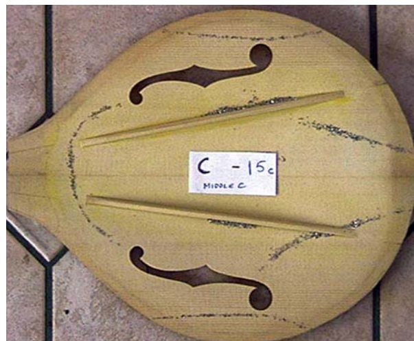
Padrões de Chladni numa tampa de violino, ilustrando um modo de vibração
